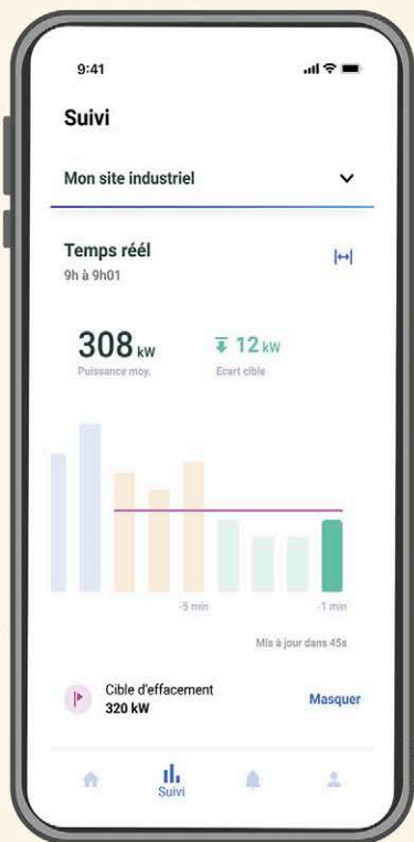
Suivi de la consommation électrique d'un site en temps réel sur l'application Caps développée pour être consultée sur un smartphone.
